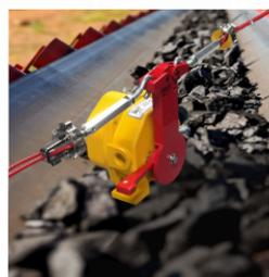
Les arrêts d'urgence à câble double **SRS** sont conçus pour fournir une sécurité totale sur toute la longueur des machines à risque pour l'utilisateur, tels que les convoyeurs à bande. Jusqu'à 2 x 75 m.
