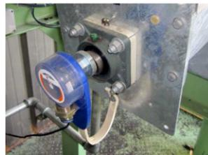
Montage rapide en bout d'arbre : Magnétique ou Assemblage M12 (M16 en option),
