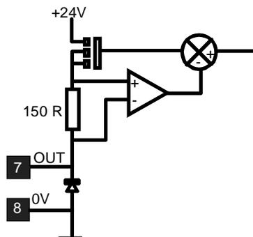
Pour transformer la sortie 4-20 mA en sortie 0-10 V :
