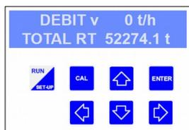
**Xscales** incorpore également un module de télémaintenance permettant d'accéder à distance aux calculateurs TMX110 et TMX400. Cette « télécommande » permet d'effectuer les manipulations générales comme la mise à zéro (tarage) ou le relevé de compteurs mais aussi le diagnostic et la correction d'étalonnage, la restauration des paramètres.
